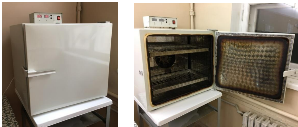
Рис. 1.3. Сухожарова шафа – прилад для стерилізації скляних та металевих об'єктів під дією гарячого повітря, що циркулює всередині камери (авторські фото)
