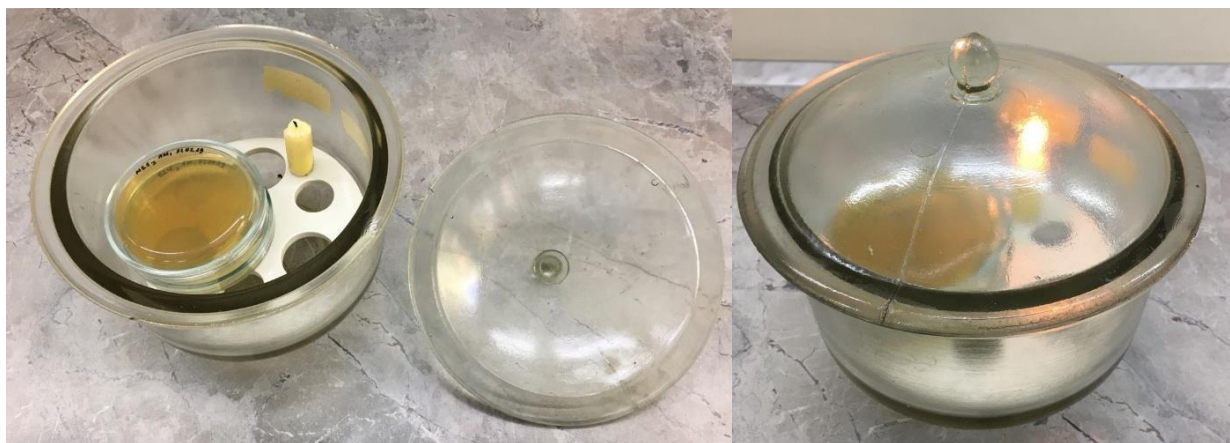
Рис. 3.1. Відкритий ексикатор з кришкою (А) та закритий (Б) (авторські фото) Примітка: У закритому герметично ексикаторі випалюється кисень за рахунок горіння свічки, що призводить до створення мікроанаеробних умов, сприятливих для росту мікроаерофілів.
