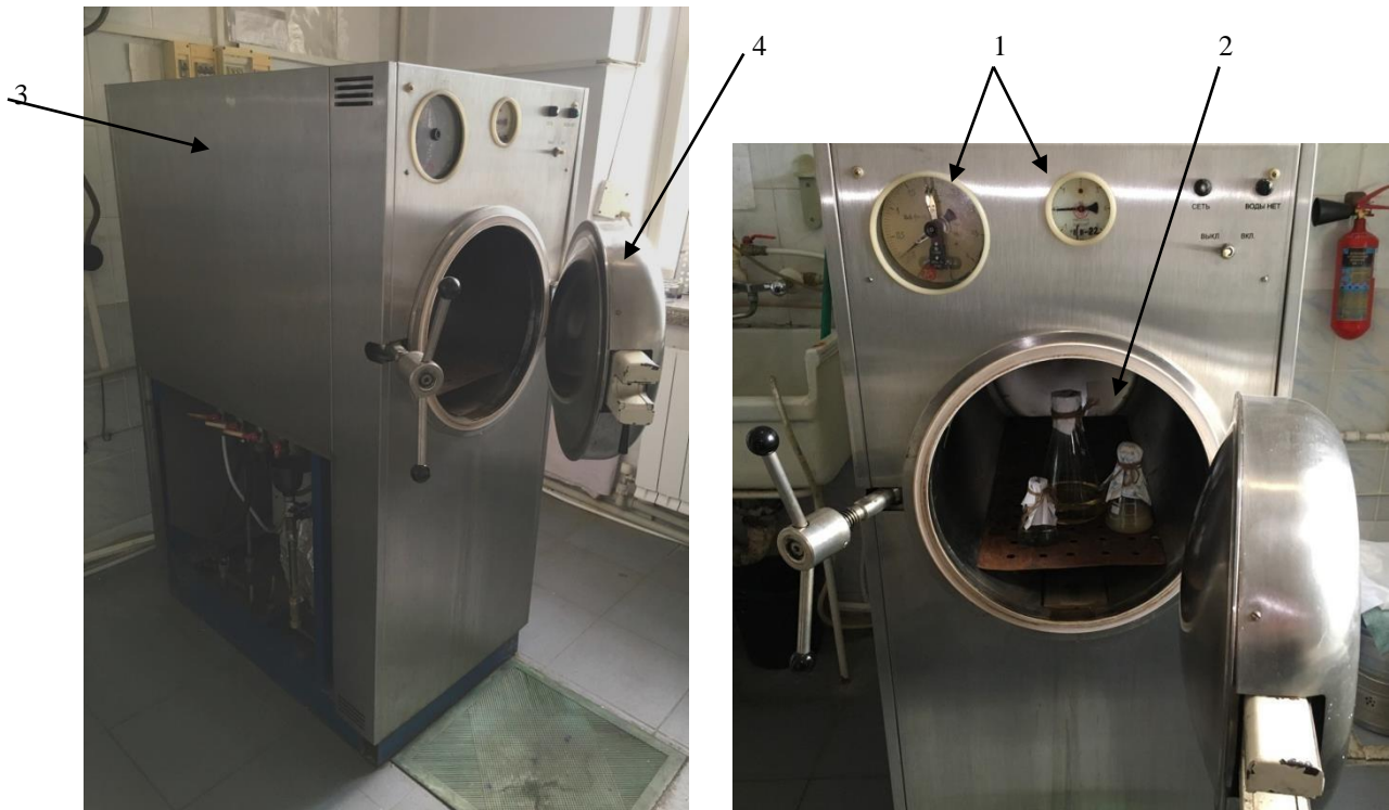
Рис. 1.4. Автоклав – прилад для здійснення парової стерилізації під тиском (авторські фото)
