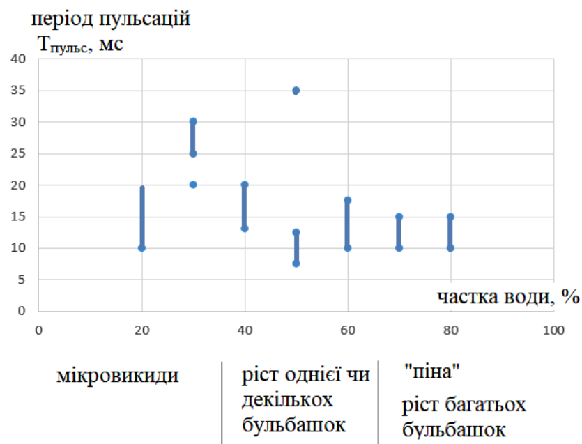
Рис. 2.14. Характерні періоди пульсацій розміру крапель емульсій в залежності від частки води.
