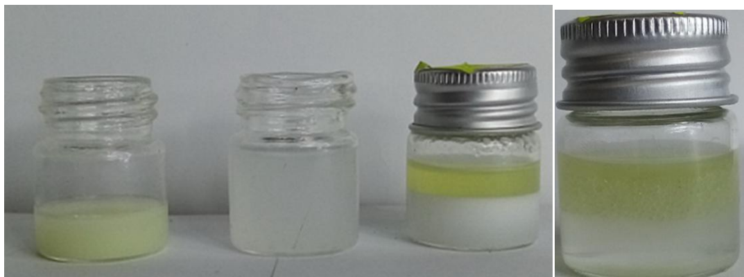
Рис. 2.4. (Зліва направо). Дизельне паливо і вода після дії ультразвукового зонду і емульсія після відстоювання приблизно добу.
