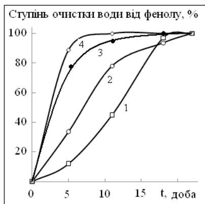
Рис. 1. Ступінь очищення води від фенолу (%) протягом часу (t, доба) за дії окремих штамів P. ceracia ONU327 (1); P. fluorescens ONU328 (2), P. maltophilia ONU329 (3) та бактеріальної асоціації P. ceracia ONU327, P. fluorescens ONU328 і P. maltophilia ONU329 (1:1:1 за об'ємом) (4).
