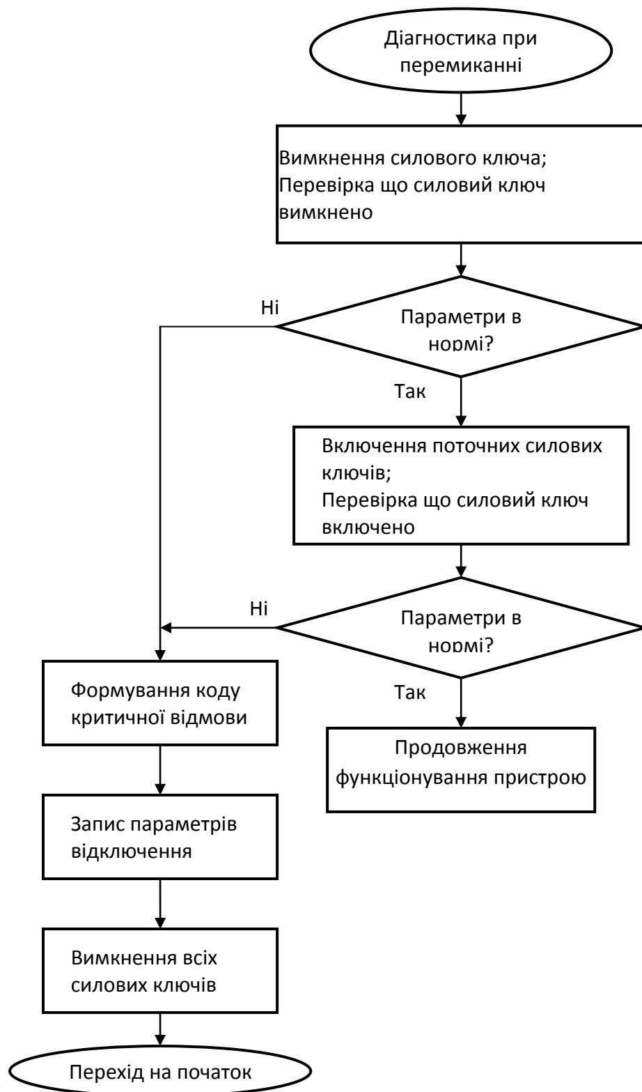
Рисунок 3.6 – Алгоритм діагностики при перемиканні силових ключів
