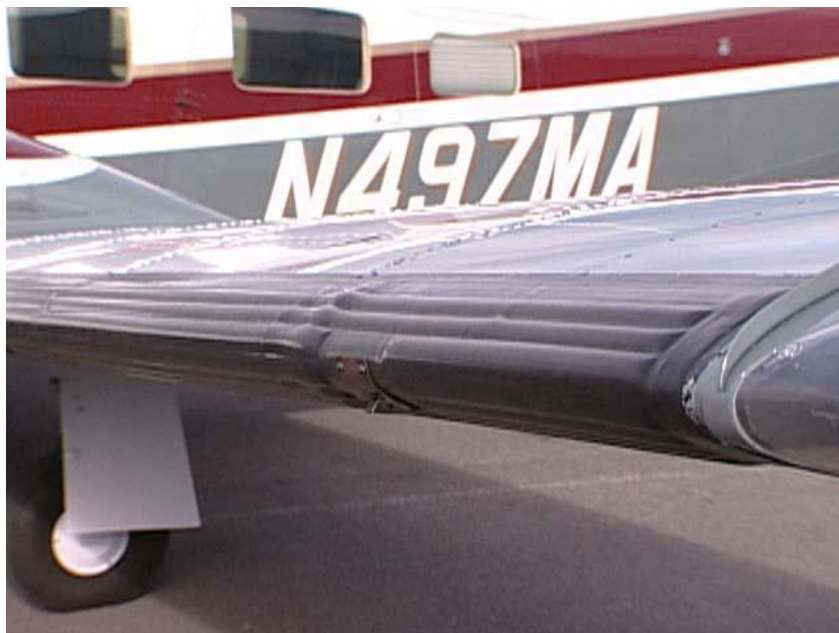
Рисунок 2.1 – Пневматичний метод боротьби з обмерзанням
