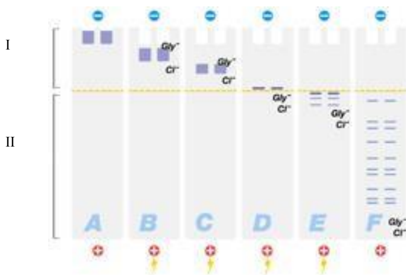
Рис. 3.2. Будова гелю та схематичне пояснення процесу, що відбувається під час електрофорезу білків: I – гелю для концентрування, рН 6,8, II – гелю для розділення, рН 8,8, Gly - – аніони гліцину, Cl - – аніони хлору [https://www.bio-rad.com/en-ua/applications-technologies/protein-electrophoresis-methods?ID=LUSOW4GRI].
