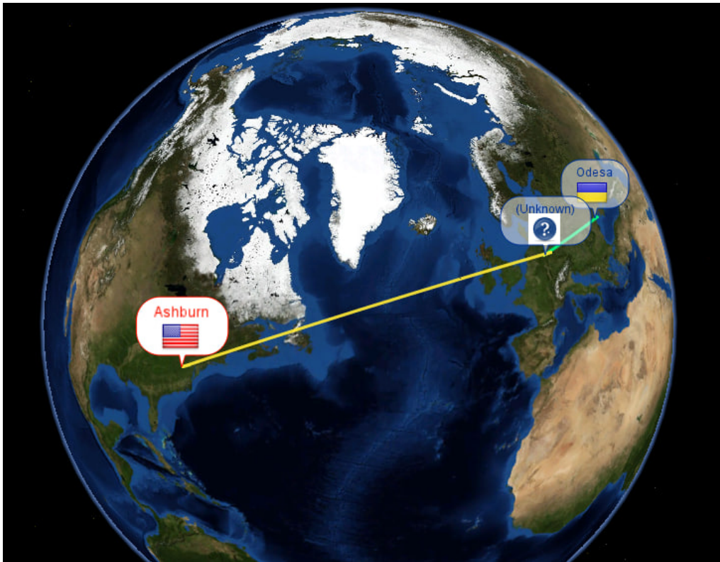
Рисунок. 3.2. — Глобальне розташування вузлів тестування: локальний хост в Одесі та сервер хостингу в Одесі та сервер хостингу glitch.com в США (отримані за допомогою програми Open Visual Trace Route 2.1.0.)
