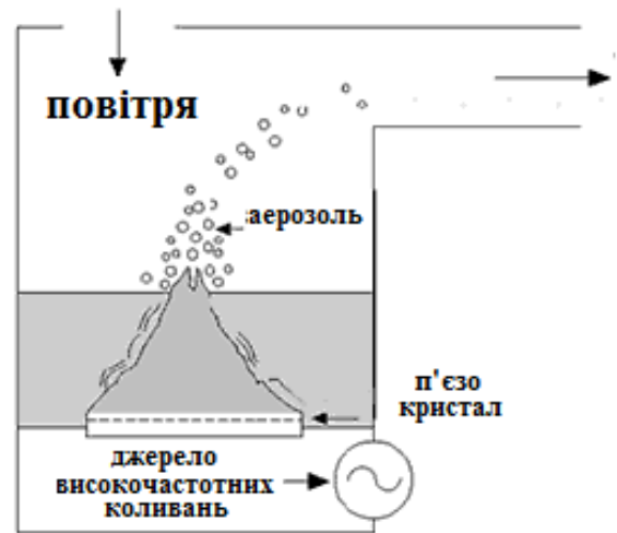
Рис. 7.6. Схема ультразвукового небулайзера (O'Calaghan & Barry)
