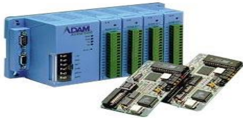
Рисунок 2.19 – Контроллер ADAM с функцией нечеткой логики
