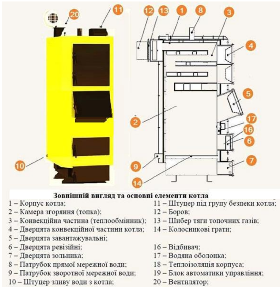
Рисунок 1.3 – Схема твердопаливного котла KRONAS
