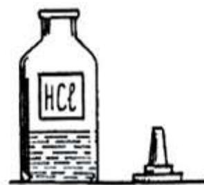
Так треба ставити пробку, відкривши посудину з реактивом
