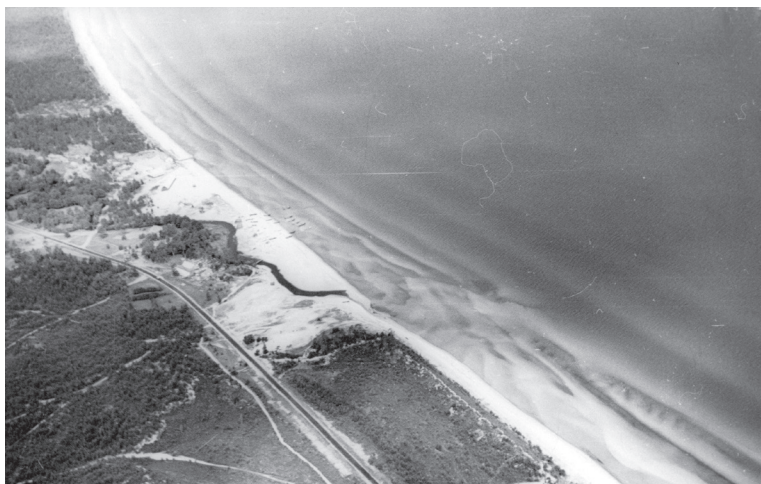
Рис. 1. Ділянка піщаної берегової зони Ірбенської протоки із 6 підводними валами та сильними вздовжбереговими хвильовими течіями на підводному схилі, в літодинамічному районі розпорошення піщаного потоку наносів (Балтійське море).
