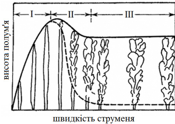
Рис. 5.2. Перехід дифузійного полум'я від ламінарного до турбулентного при зростанні швидкості струменя: I – ламінарне дифузійне полум'я; II – перехідна область; III – турбулентне дифузійне полум'я
