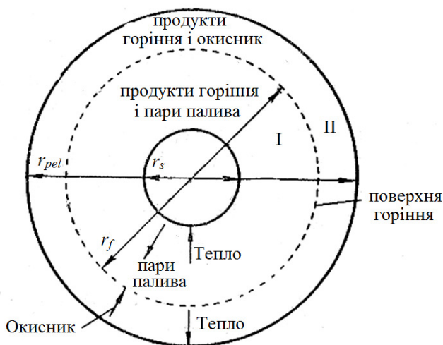
Рис. 7.1. Схема дифузійного горіння одиночної краплі
