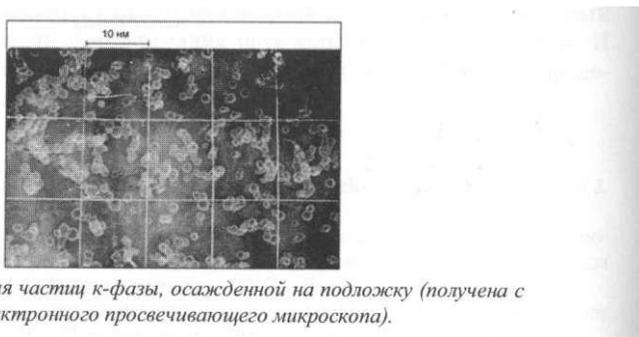
Рис. 1. Фотография частиц к-фазы, осажденной на подложку (получена с использованием электронного просвечивающего микроскопа).
