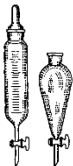
Рис. 1.2. Ділильні воронки для проведення екстракції
