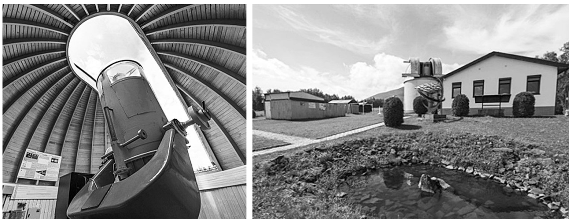
Телескоп с диаметром главного зеркала 1 м, установленный в горах Выгорлат в Словакии в 2000 году
