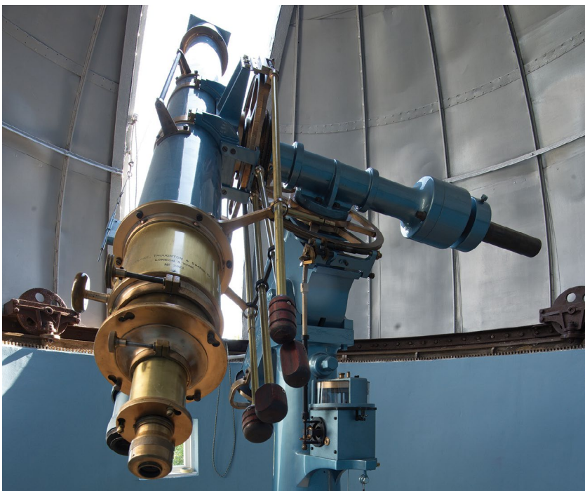
165-мм рефрактор Кука, приобретенный в 1886 году. Фото после реставрации телескопа в 2019 году
