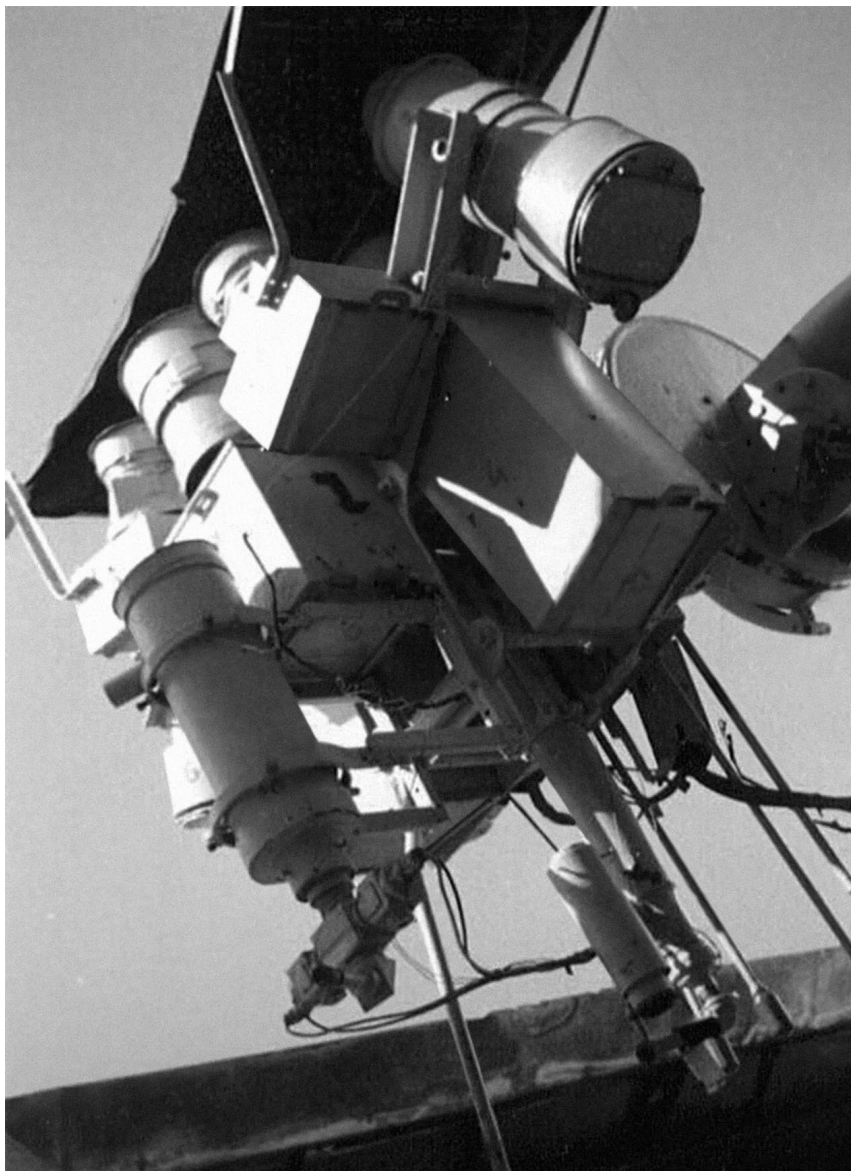
Семикамерный астрограф (1957—1998), по наблюдениям на котором получено более 80 000 фотографических снимков, составивших основу третьей в мире Одесской коллекции снимков звездного неба
