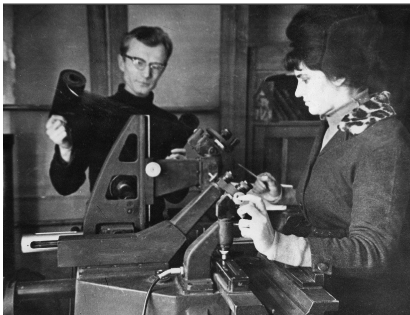
А. К. Маркина и Ю. Д. Руссо измеряют астронегативы с помощью измерительной машины УИМ-2
