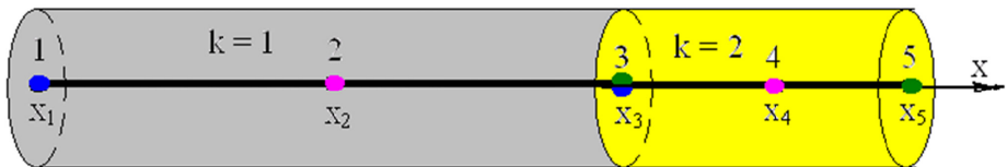
Рис.1.13. Нумерація кінцевих елементів і вузлів апроксимації стрижня, розділеного на два однорідних елемента
