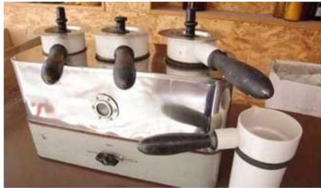
Рис. 1. Деколятор (а), інфундирка (б) та інфундирний апарат (в)
