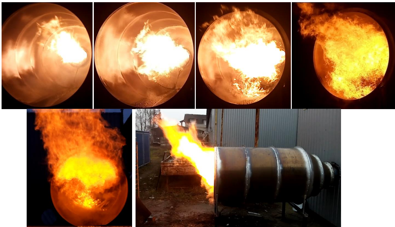
Рис. 1.3. Якісна зміна зовнішнього вигляду факела всередині сопла при горінні емульсії М45В55 зі збільшенням масової витрати емульсії
