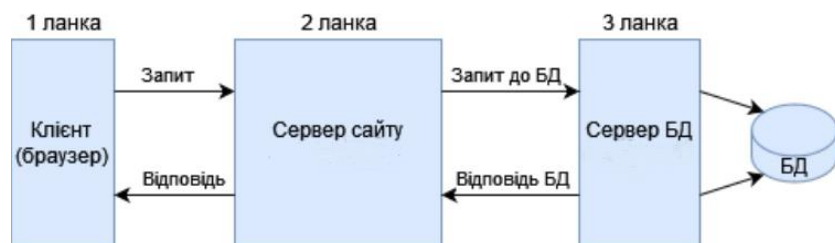
Рисунок 3.1 – Трирівнева архітектура клієнт-сервер
