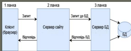
Рисунок 2 – Трирівнева архітектура клієнт-сервер
