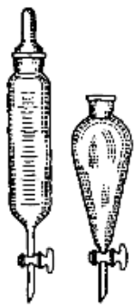
Рис. 1.2. Ділильні воронки для проведення екстракції
