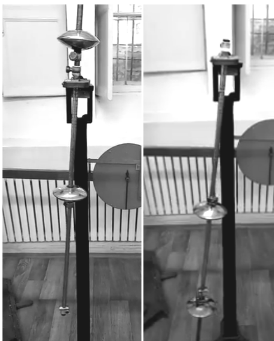
Рис. 2.8. Перше та друге положення фізичного маятника
