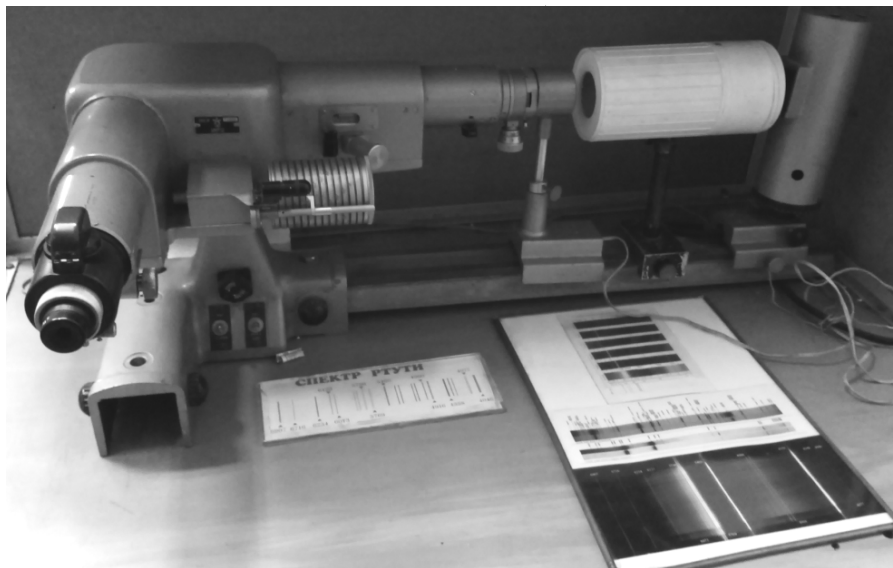
Рис. 3.23. Експериментальна установка для спектрального аналізу
