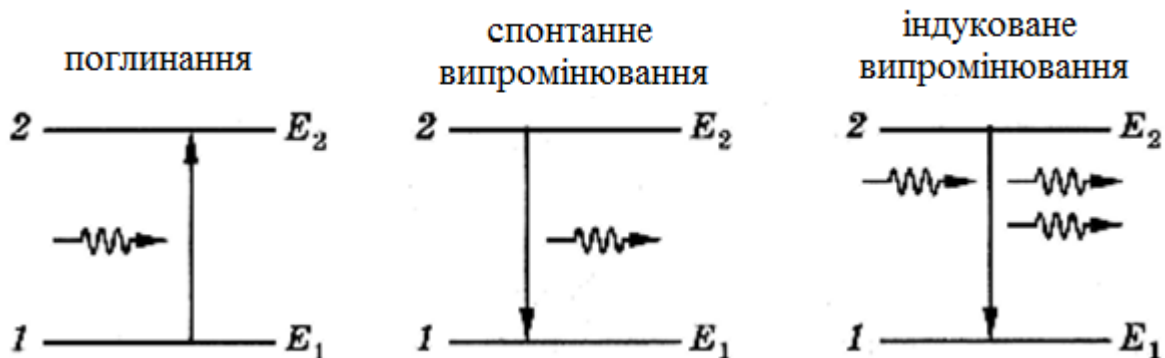
Рис. 3.26 Спонтанне та індуковане випромінювання атомів
