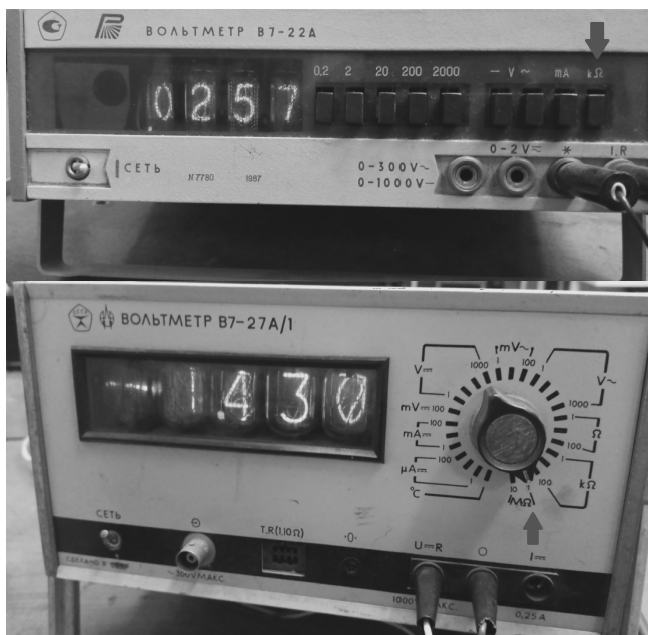
Рис. 3.9. Для визначення одиниць вимірювання опору металу (зверху) та напівпровідника (знизу)
