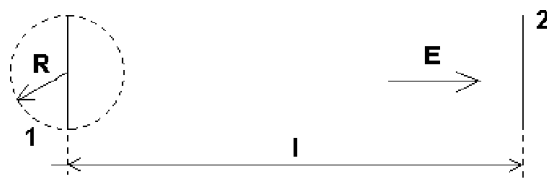
Рис. 3. Излучение источником на поверхность датчика. 1 — источник излучения; 2 — чувствительная поверхность датчика пирометра; l — расстояние от источника до поверхности датчика; R — радиус частицы.
