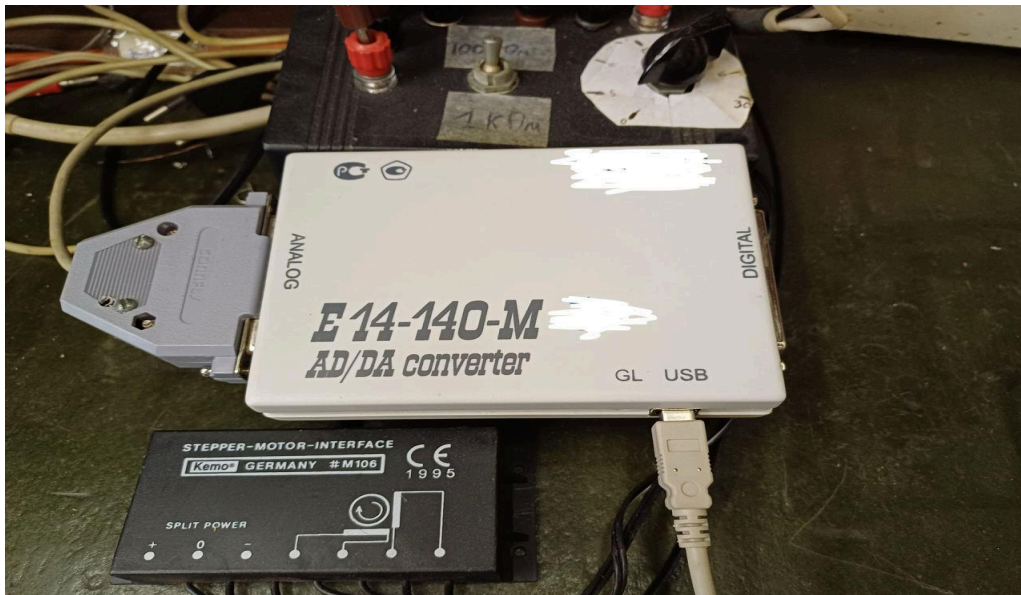
Рис. 5. Фрагмент установки для автоматизованого запису ВАХ.
