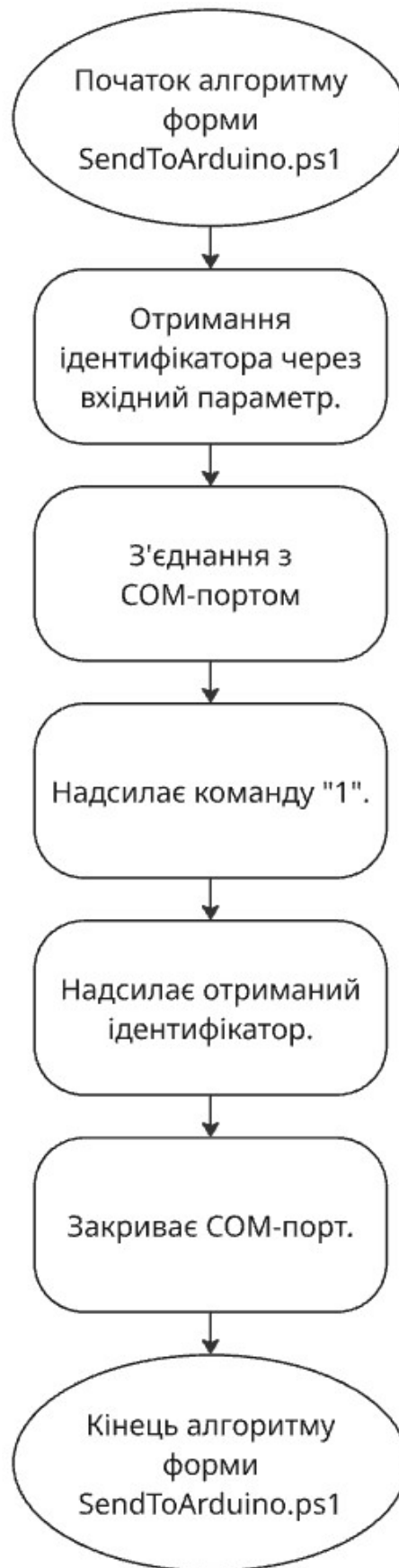
Рис. 7.1. Блок-схема алгоритму SendToArduino.ps1 .
