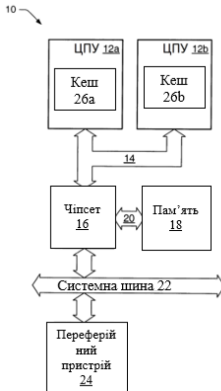
Рис. 3.1. – Архітектура з двома процесорами
