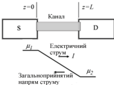
Рис. A1.2. До розв'язування системи рівнянь (A1.1) і (A1.10) з крайовими умовами (A1.11). Як і в [1], завжди використовується напрям струму від витоку (S) до стоку (D), тотожний напрямові руху електронів і протилежний до загальноприйнятого в силу історичних причин напрямку струму від «плюса» до «мінуса».
