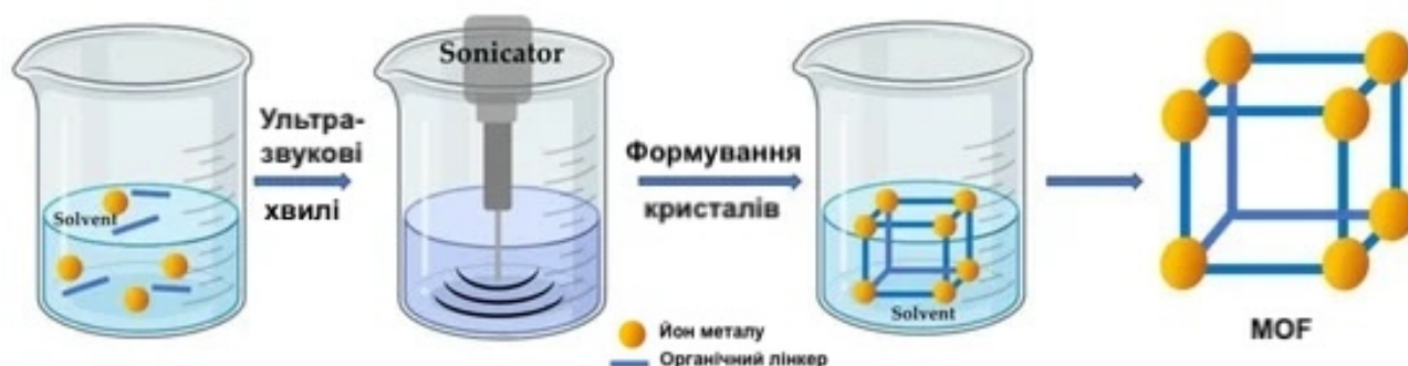
Рис. 1.3. Схематичне зображення ультразвукового методу синтезу MOF [7]
