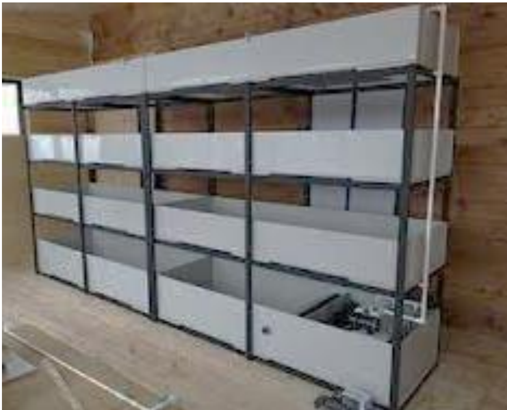
Рис. 12 – Установка замкнутого водопостачання для креветок
