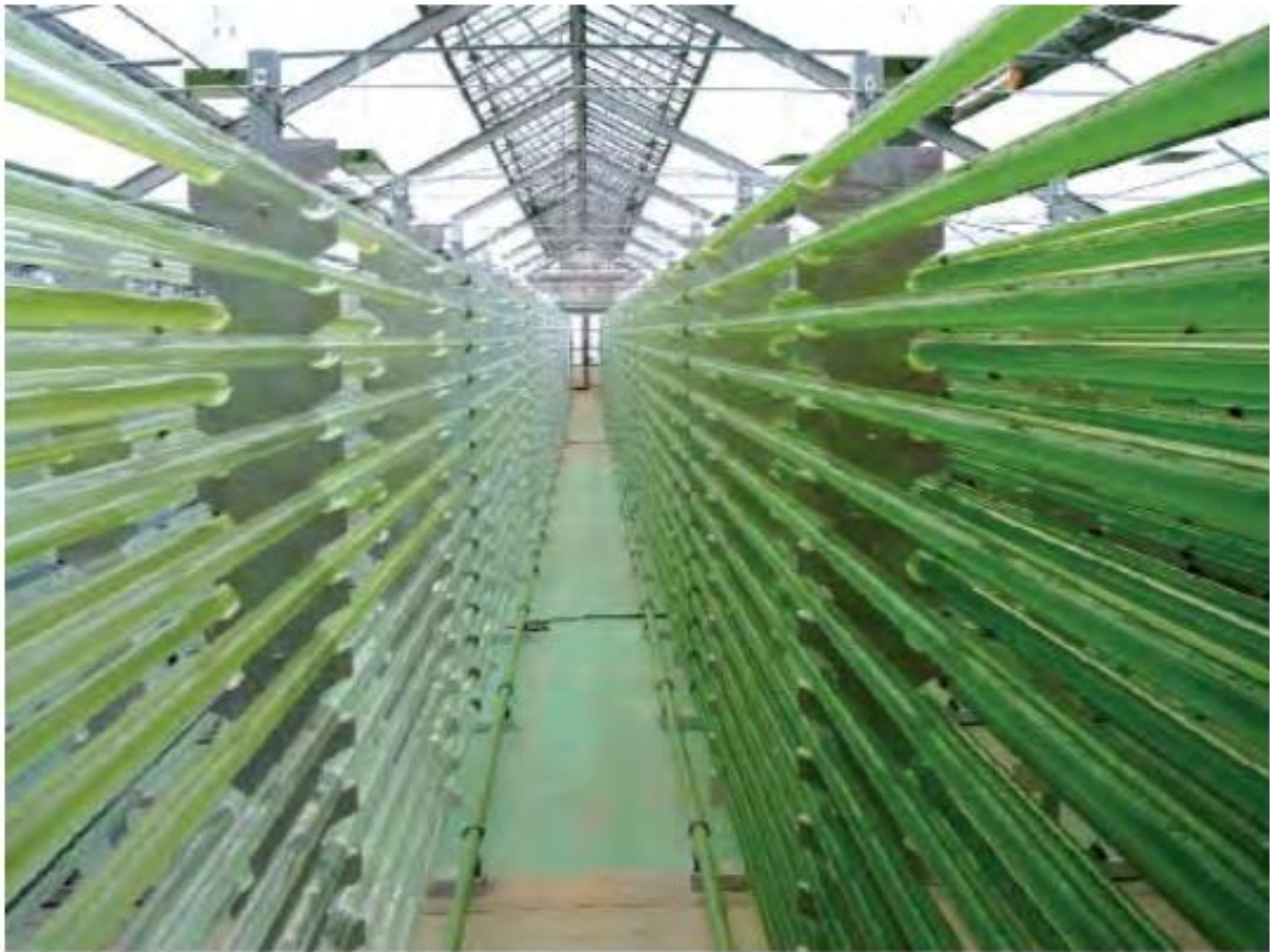
Рис. 3 – Зовнішній вигляд промислового фотобіореактора
