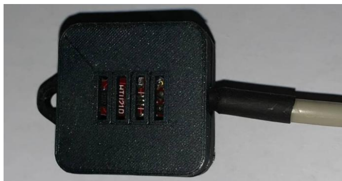
Рисунок 2.14 Датчик температури та вологості повітря.
