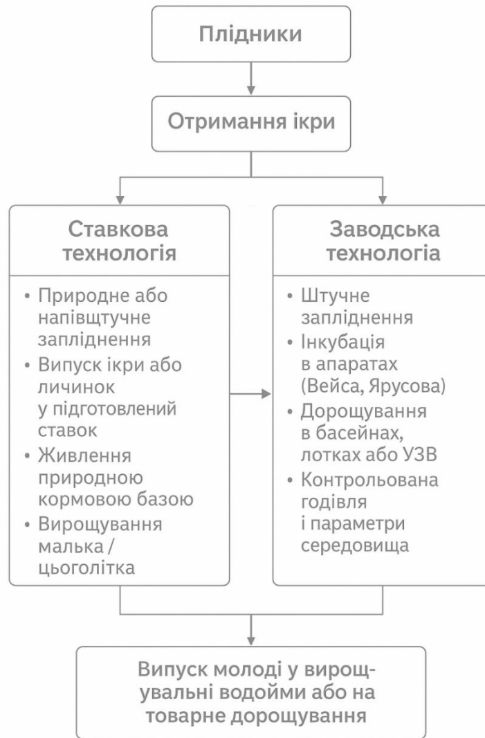
Рис. 9.1. Схема інкубаційного та дорощувального циклу риби у ставковій та заводській технологіях
