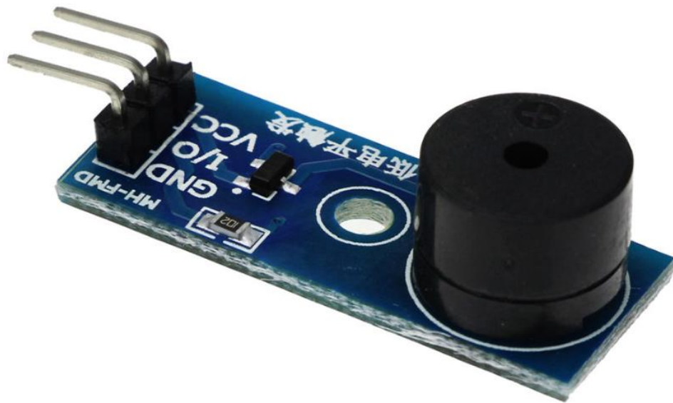
Рисунок 2.11 – Зовнішній вигляд модуля п'єзодинаміка
