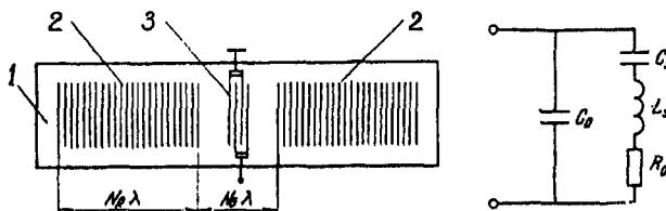
Рис. 2, а) структура одновходового резонатора на ПАВ. 1 — пьезоэлектрический звукопровод, 2 — отражательные структуры, 3 — бесконтактный ВШП,  $N_R \lambda$  — ширина отражателя,  $N_G \lambda$  — ширина резонансной полости; б) эквивалентная параллельная электрическая схема ВШП.  $C_0$  — статическая емкость,  $R_0$  — сопротивление излучения,  $C_s$  и  $L_s$  — эквивалентные динамические емкость и индуктивность
