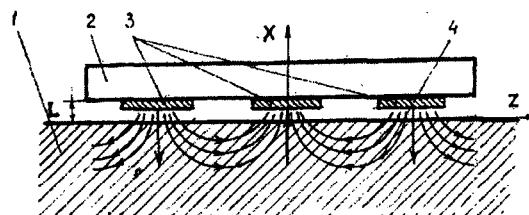
Рис.1. Схематическое представление бесконтактного ВШП. 1 — диэлектрическая пьезопассивная подложка, 2 — электроды ВШП, 3 — пьезоэлектрический звукопровод, 4 — геометрия электрического поля
