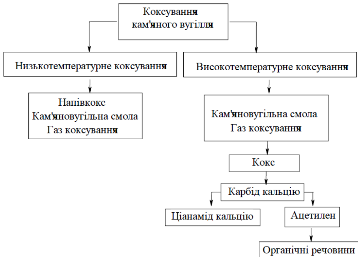
Рис. 2.4. Схема перероблення кам'яного вугілля коксуванням
