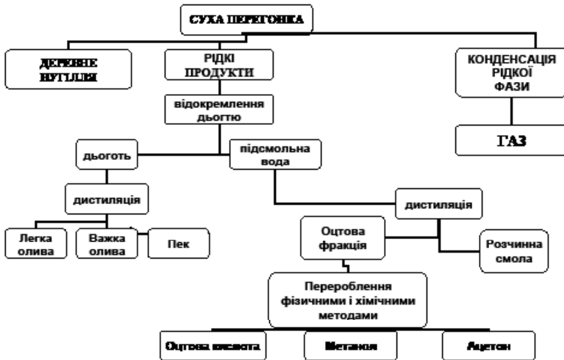
Рис. 1.10. Схема розділення продуктів сухою перегонкою деревини
