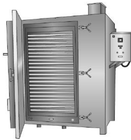
Рис. 14. Промислова установка для сушки вологих гранул
