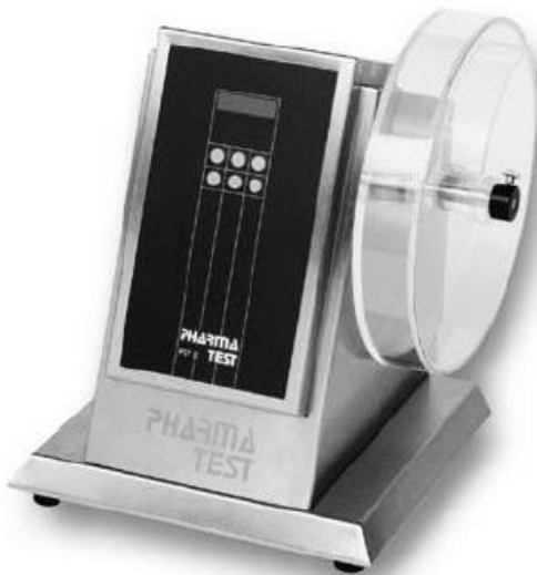
Рис. 21. Прилад для визначення міцності таблеток на стирання
