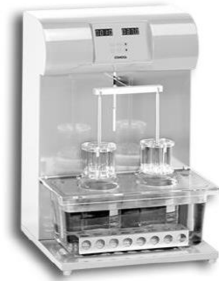
Рис. 23. Прилад для проведення тесту на розпадання
