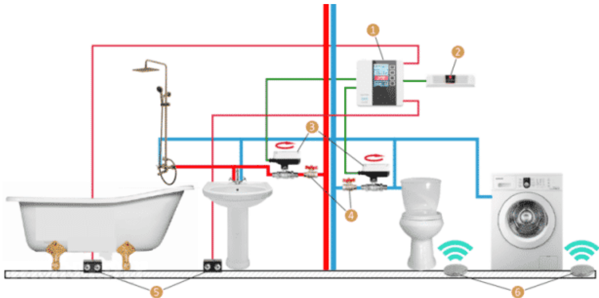
Рисунок 2.1 – Схема контролю витoku води
