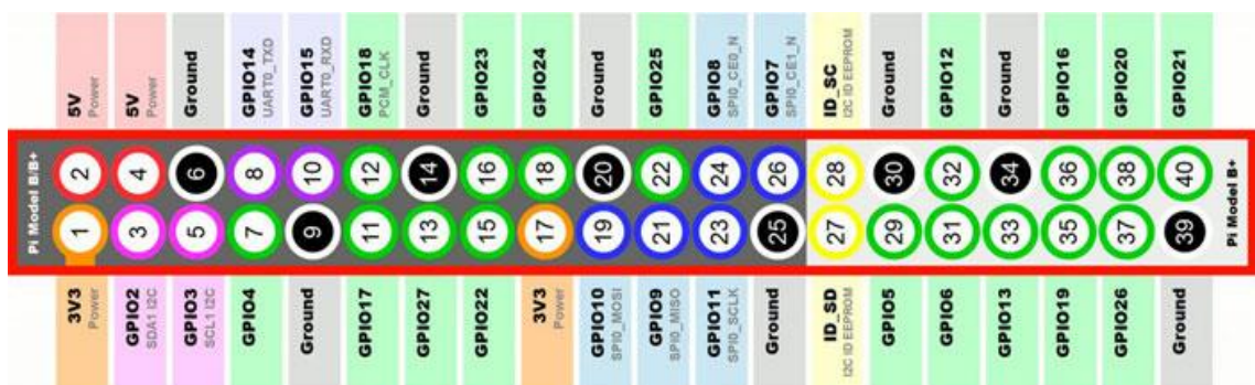
Рисунок 3.10 – Розпіновка GPIO роз'єму Raspberry PI 3 model B+
