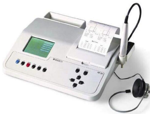
Рис. 21. Імпедансометр діагностичний Maico MI 34 [9]
