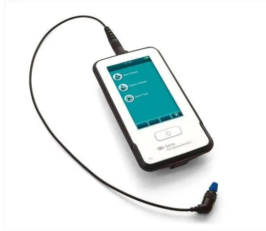
Рис. 22. Портативний автоматизований аудіометр Serainteracoustics [10] Призначення: для швидкого скринінгового обстеження слуху новонароджених.
