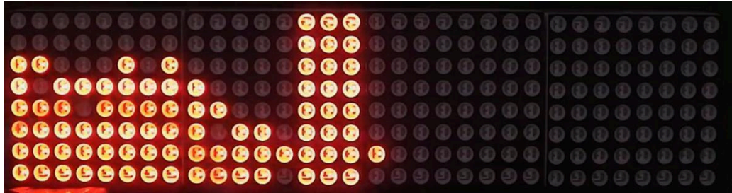
Рисунок 3.5 – Відображення аудіоспектру на світлодіодній матриці 8x32
