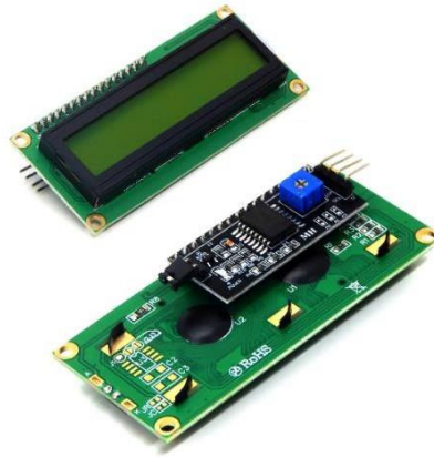
Рисунок 2.8 – Дисплей LCD1602 з I 2 C-модулем
