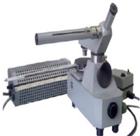
Рис. 20. Столик "Боеціус" – прилад для виміру температури плавлення
