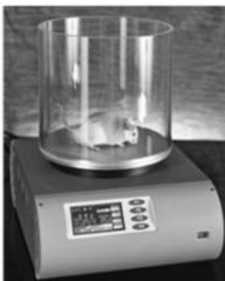
Рис. 11. Тестова установка «гаряча пластина»
