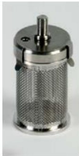
Рис.1 Прилад «Обертаючий кошик» та основні його частини
