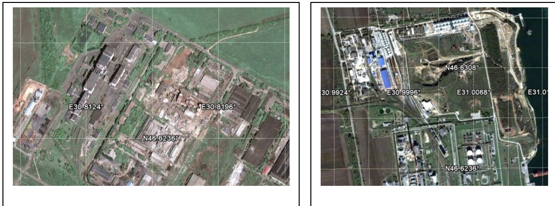
Рис. Б7. Території промислових підприємств (мають чіткі межі, помітні специфічні будівлі – цехи, цистерни тощо)
