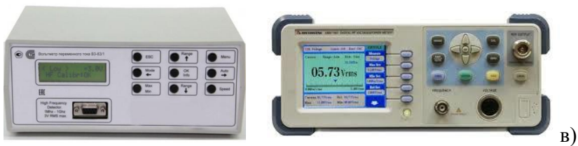
Рис. 2.28. Цифрові вольтметри: а) універсальний В7-82, б) мультиметр тестер переносний (вольтметр, амперметр), в) змінного струму.
