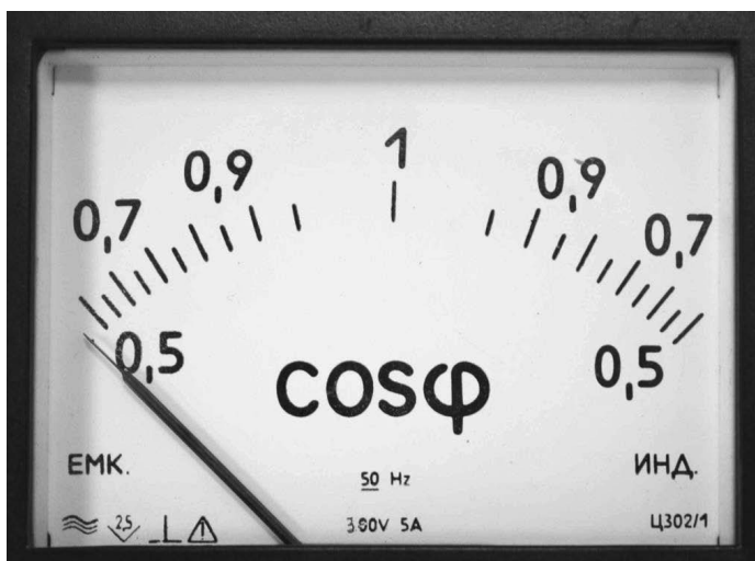
Рис.1.4. Лицьова панель фазометра класу точності 2,5 з нерівномірною шкалою.
