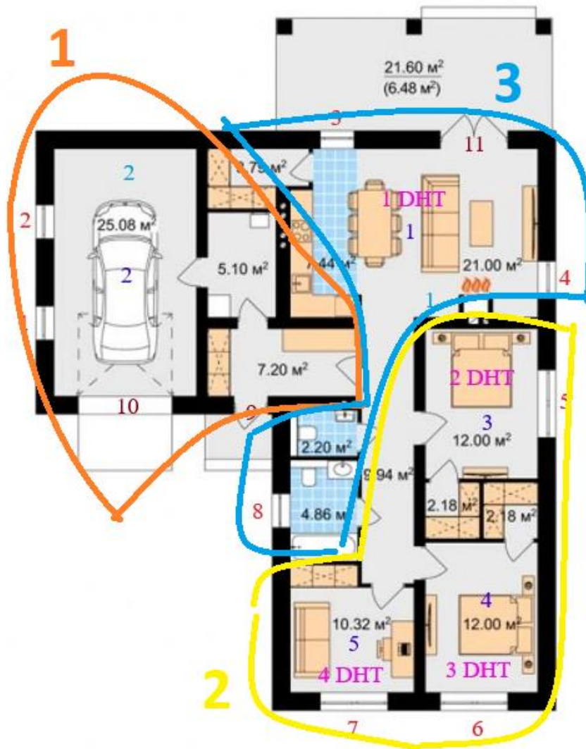
Рисунок 2.3 – Розподіл зон управління розумного будинку
