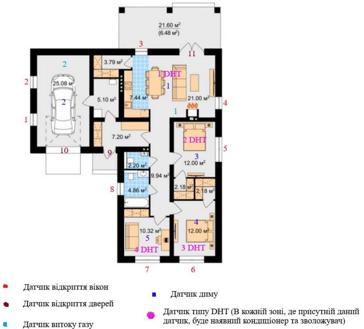
Рисунок 2.2 – Розтошування сенсорів на плані будинку
