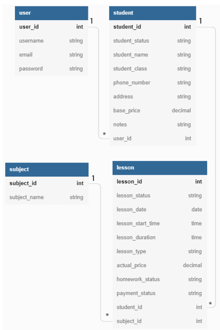
Рисунок 3.1 – ER-діаграма бази даних кросплатформного застосунку для організації роботи репетиторів
