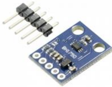
Рис. 2.1.1 – Світлочутливий модуль датчика освітленості BH1750
