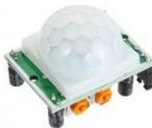
Рис. 2.1.3 – Піроелектричний інфрачервоний (PIR) датчик руху HC-SR501
