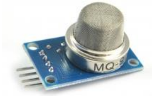
Рис. 2.1.4 – Датчик природного газу MQ-9
