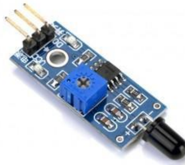
Рис. 2.1.5 – Модуль полум'я на датчику KY-026
