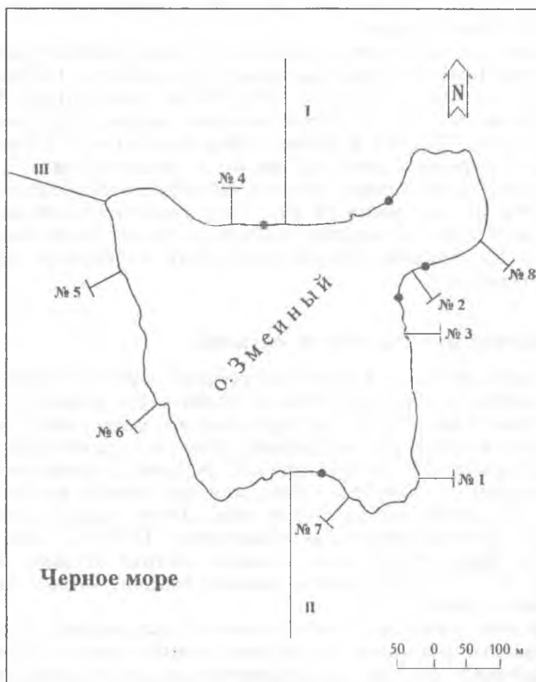
Рис. 1. Схема отримання фактичного матеріалу під час досліджень на о.Зміїний, Чорне море. I–III — криві пересіків підводного схилу в різних частинах острова; № 1 – № 8 — пересіки кліфів різної морфології; чорні точки показують місця відбору зразків наносів і вимірювання розмірів уламків породи
