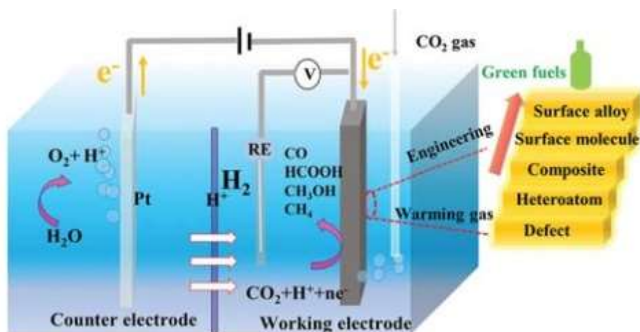
Рис. 1.11. Схема електрохімічного відновлення CO 2 у зелене паливо
