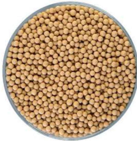
Рис. 1.4. Синтетичний цеоліт СаА – поглинач \text{CO}_2 , алюмосилікат з високим ступенем стійкості до слабких кислотних середовищ
