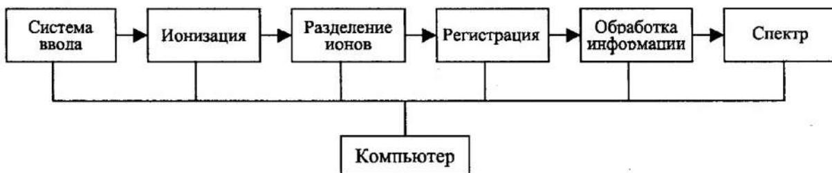
**Рис.2** Блок-схема масс-спектрометра
